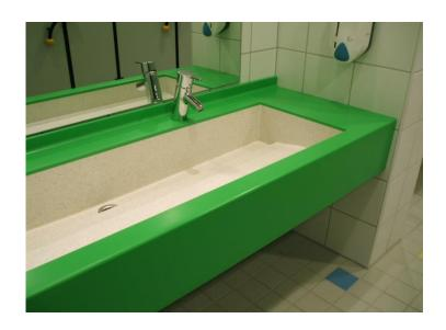
Marlan® freitragende große Waschrinne Sargasso 450 - 550 mm, komplett mit Frontschürze bis 200 mm hoch, 200 mm hoch Montageschürze mit Löcher 16 x 32 mm. Integrierte Waschrinne mit variable Länge ab 500 mm und breit 350 mm Innenmaß und Ablauf in der Mitte
