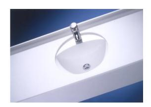
Marlan® freitragender Waschtisch Alpha, 550 mm tief komplett mit abgerundeter Frontschürze bis 200 mm hoch, integrierter Wischleiste 40 mm hoch, integriertem Waschbecken Modell Delta rund 420 mm Innenmaß mit abgesenkter Armaturenbank, Überlauflochbohrung, Korbventil und Überlaufgarnitur. Ohne Stützkonsolen und MDF Montagestreifen..
