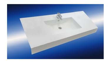
Marlan® freitragender Waschtisch 550 mm tief komplett mit abgerundeter Frontschürze bis 200 mm hoch, integriertem rechteckiges Waschbecken Modell Swing 535 x 321 mm Innenmaß mit Überlauflochbohrung, Korbventil und Überlaufgarnitur. Ohne Stützkonsolen und MDF Montagestreifen.
